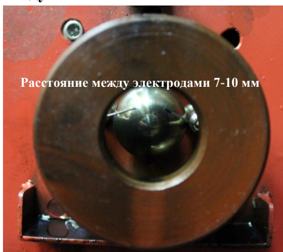
Установка электродов розжига на форсунке №1
